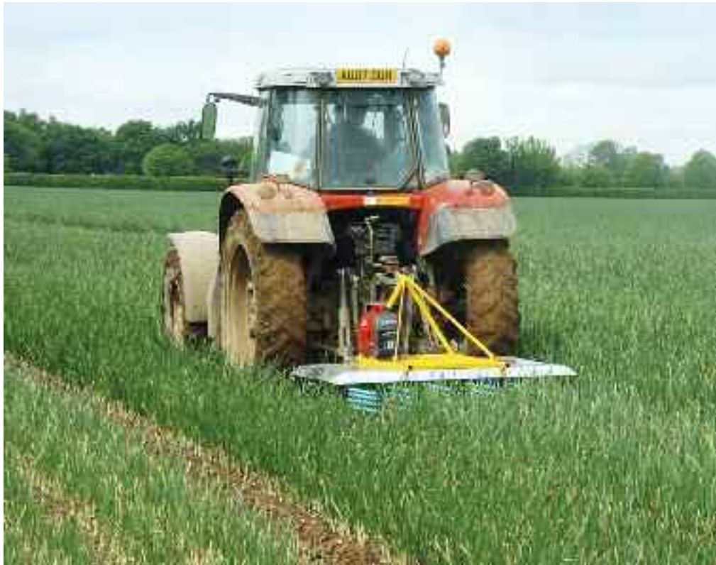
LØGSKIMMEL – Prototype af UV-belysningsmaskine i løg med lodret placerede UV C-lysrør, således at løgne bliver belyst fra begge sider. Strømforsyningen sikres af en generator trukket af en benzinmotor.
