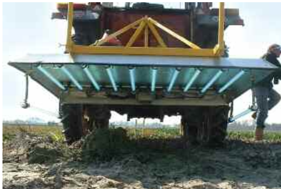
FLADEBELYSNING - Prototype, hvor lamperne er placeret under en skærm, der fungerer som en parabol.
